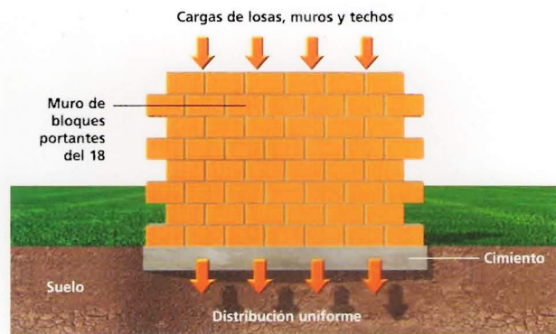
Fig. 1 Distribución de cargas en muros portantes
